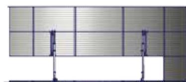
Anheben des Behälters Lifting the tank
