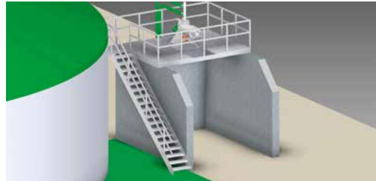
Separator auf Betonpodest mit Überlaufsystem. Separator on a concrete platform with overflow system.
