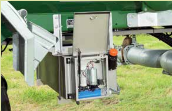
Dosieranlage für Nitrifikationshemmer
