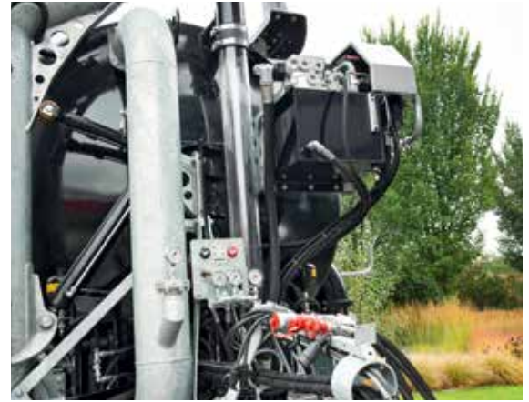
Pumptankwagen mit Bordhydraulik und Drehkolbenpumpe
