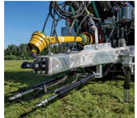
Deichselfederung mit Zwangslenkung
