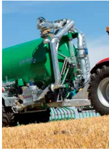
Saugrüssel mit zwei Drehgelenken
