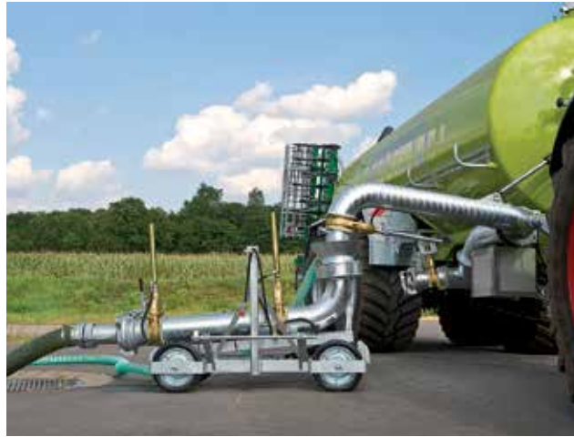
Andockstation für Hochbehälter und Gruben
