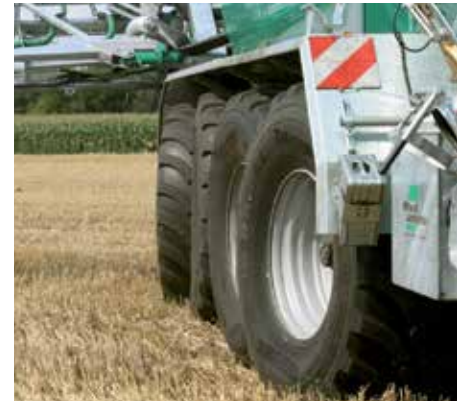
MultiSteeringSystem (MSS) – alle Achsen werden gelenkt
